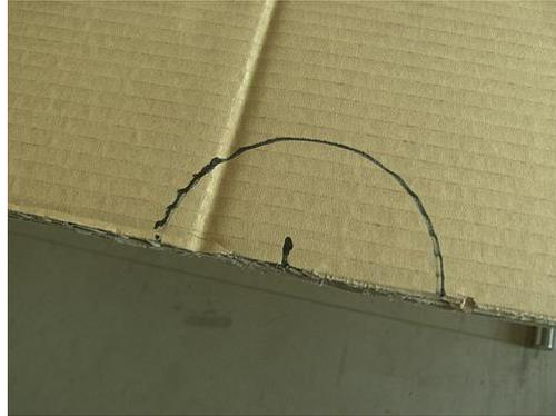
Nun legt man ein Brett oder eine Dachlatte so an den Markierungsstrich an, dass es/sie mit der Kante des Kartons einen Winkel von etwa  $15^\circ$  bildet und biegt den Karton soweit, dass ein Knickfalz entsteht. Es geht leichter, wenn sich jemand auf das Brett stellt. Nun dreht man das Brett ein wenig um die Markierung am Rand und knickt erneut. Diesen Vorgang wiederholt man so oft, bis man ca. 14-16 Knicke hat, die sich alle in dem einen markierten
